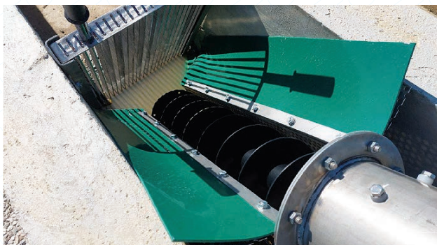
Gruba rešetka i pužni separator
