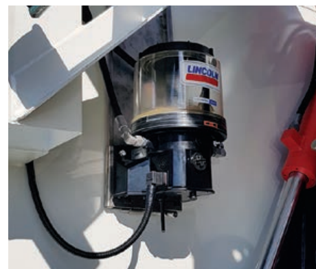
Automatsko podmazivanje kliznih površina u 14 točaka
