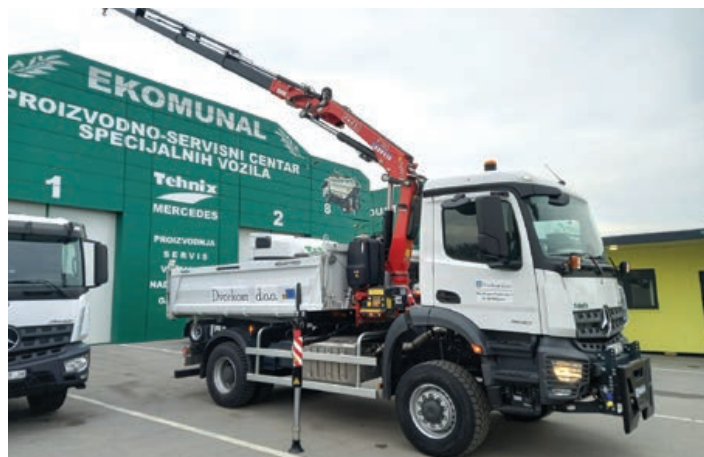
Multifunkcionalni trostrani kiper s kranom na šasiji pogona 4x4 sa zimskom službom
