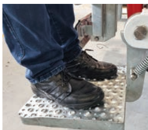
Ergonomski oblikovano stajno mjesto prema ISO 2631
