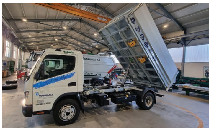
Trostrani kiper s aluminijskom nadogradnjom
