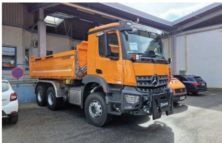
Multifunkcionalni trostrani kiper s kranom na šasiji pogona 4x4 sa zimskom službom
