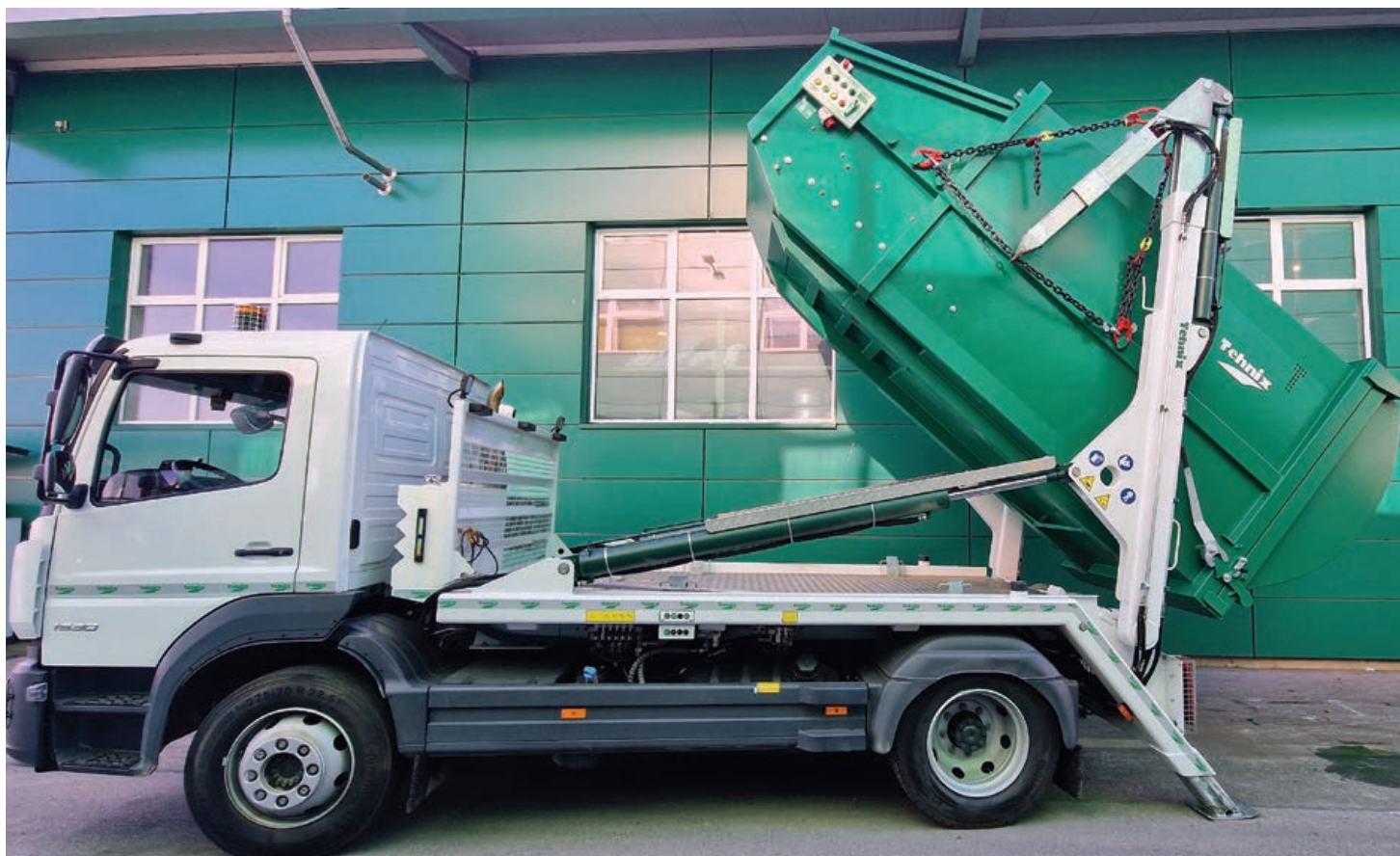
Samopodizač s teleskopskim rukama i dodatnim produžetkom za hidrauličko fiksiranje kontejnera
