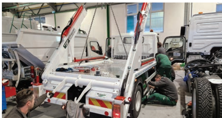
Montaža TEHNIX nadogradnje
