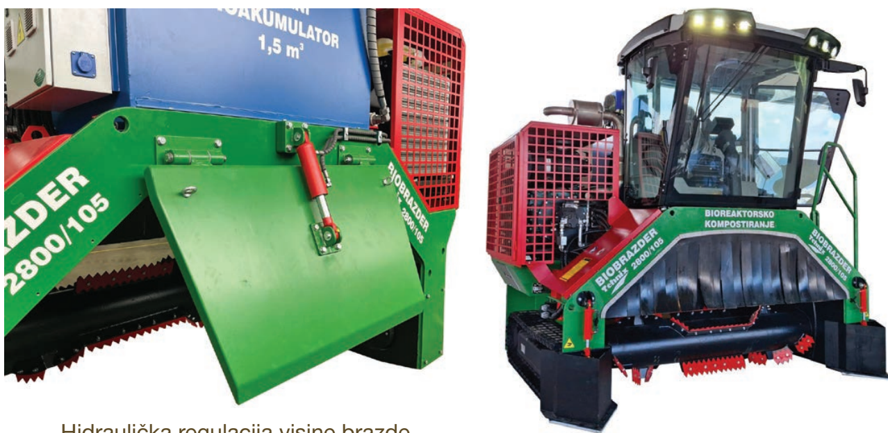
Hidraulička regulacija visine brazde
