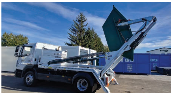
Istovar s dodatnim hidrauličkim produžetkom iznad 2 m visine
