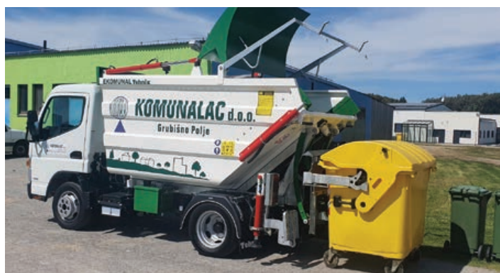
Podizanje PVC kanti i kontejnera
