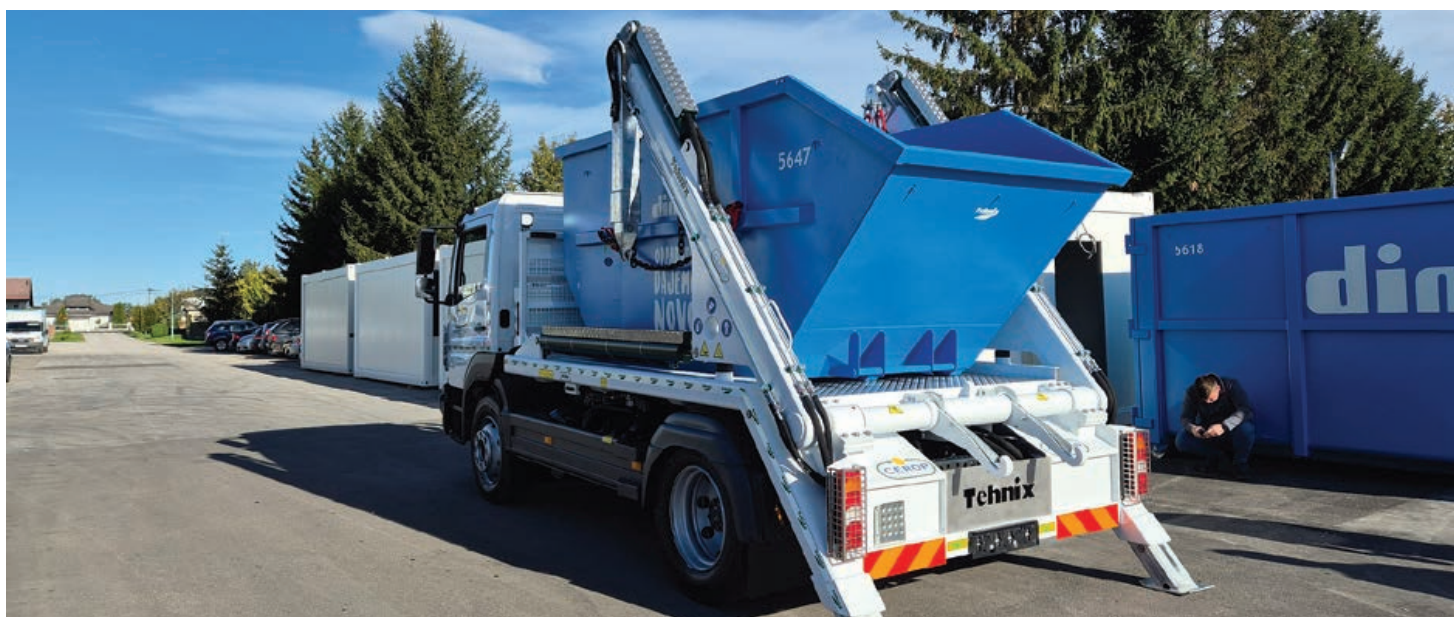
Stabilizatori i ruke pojedinačno upravljivi za lakšu manipulaciju
