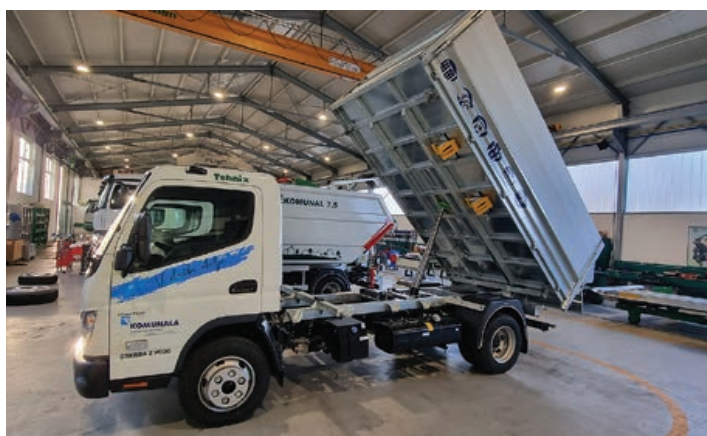
Trostrani kiper s aluminijskom nadogradnjom
