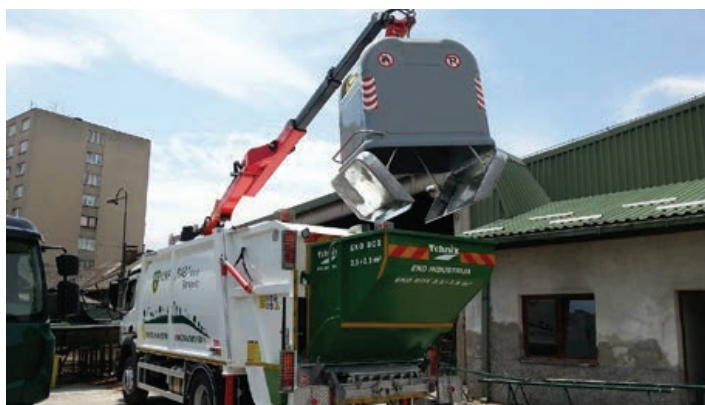
Završena montaža u tvornici EKOMUNAL vozila te isporučeno vozilo na zadatku pražnjenja zvonastih kontejnera
