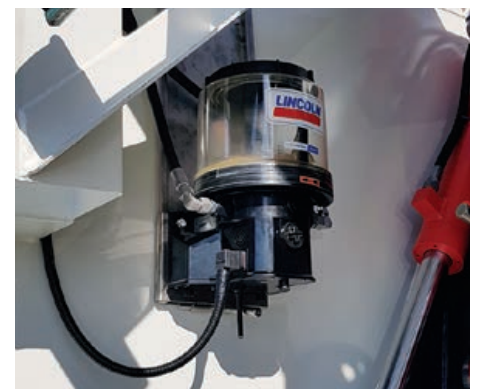
Automatsko podmazivanje kliznih površina u 14 točaka
