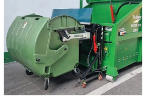
Mobilni podizač za kante i kontejnere - brza hidraulička spojka
