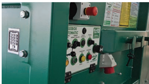
Tehnix preskontejner upravljani s elektronskom ID karticom, otiskom prsta i šifrom
