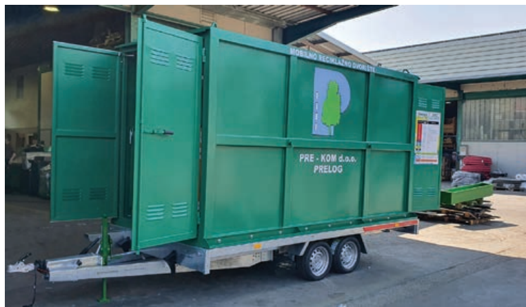
Specijalna izvedba mobilnog reciklažnog dvorišta na prikolici
