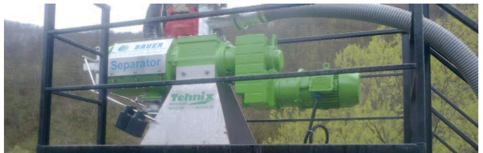
SCHLAMMSEPARATOREN FÜR BIOREAKTOREN UND BAUERNHÖFE
