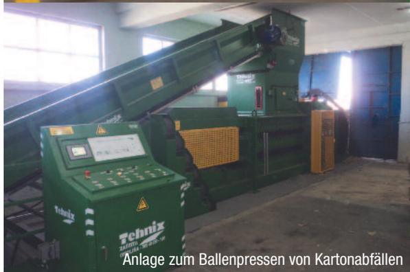
Automatische Ballenpresse mit zusätzlichen Ausrüstung für ballen des Materials und Kontrollkästchen
