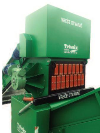
Sacköffner Typ Tehnix - Kapazität 5-20 t/h, Möglichkeit von öffnen der Säcke von 5-50 kg
