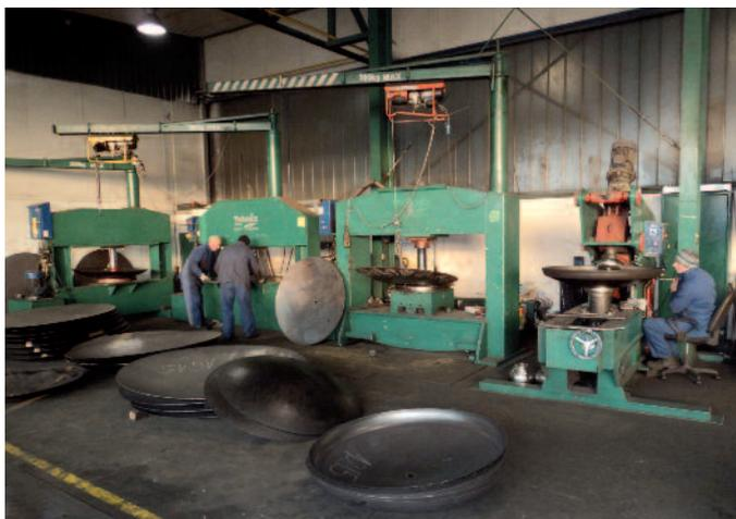
Technologische Linie für die Produktion von Körperböden, Materialdicke bis 15mm und Durchmesser von 500 bis 3000mm, nach DIN 28011 -Norm (flach) und DIN 28013 -Norm (tief)
