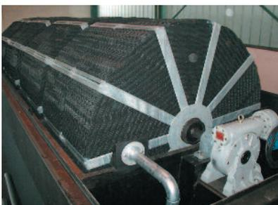
Die Rotoreinheit von biologischen Abschnitt der Maschine
