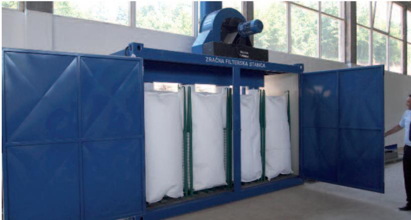
Luftfilterstation - Typ 1 (2250 x 1650 x 2500), Typ 2 (4400 x 1650 x 2500)
