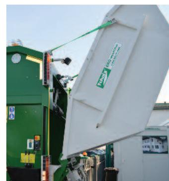
Automatische Entladung der Aufnahme-kammer innerhalb und außerhalb der Kabine
